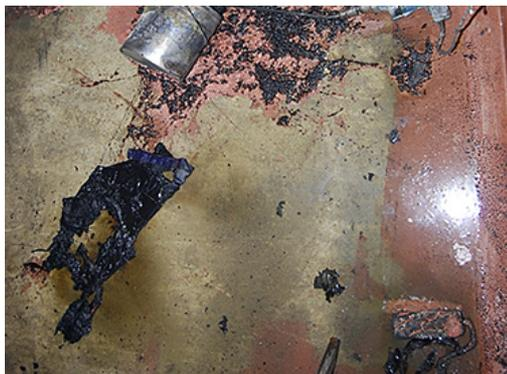
Nella vasca di raccolta non è stato utilizzato un ventilatore con tubo d'aspirazione e perciò si è formata un'atmosfera esplosiva. L'esplosione si è verificata quando l'operaio ha usato l'agitatore montato su un trapano per miscelare i vari componenti della vernice a base di solventi.
