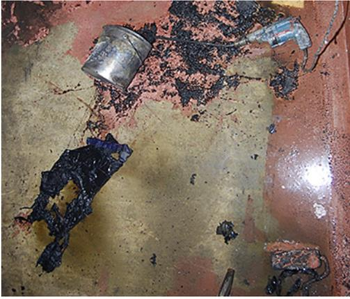
Le bac de rétention n'a pas été ventilé avec un extracteur requis en la circonstance, d'où la création d'une atmosphère explosible. L'explosion s'est produite alors que le collaborateur mélangeait les différents composants de la couche de fond à base de solvant avec une perceuse munie d'un brasseur.
